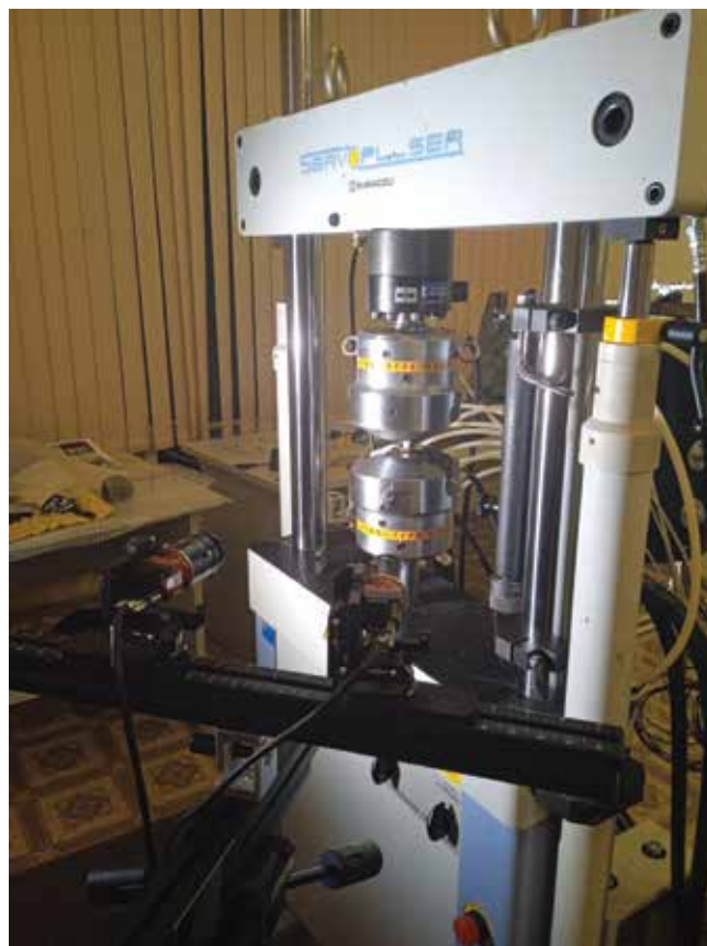
Рис. 2. Испытательная машина с гидравлическими захватами с установленным образцом для испытаний на сжатие
