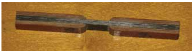
Рис. 1. Образец для исследования: h=3 , b=9 , l=13,5 мм
